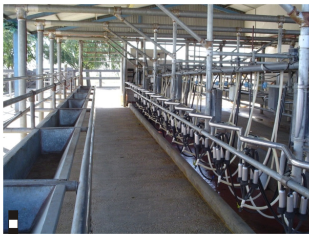
Instalación de ordeño tipo lado por lado 70° (ordeño por atrás) con zig-zag en una de las barandas de cola.
